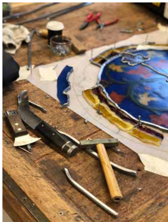
Ateliers Simon-Marq, panneau test, pétale de la baie 26 (St Joseph), sertissage au plomb
